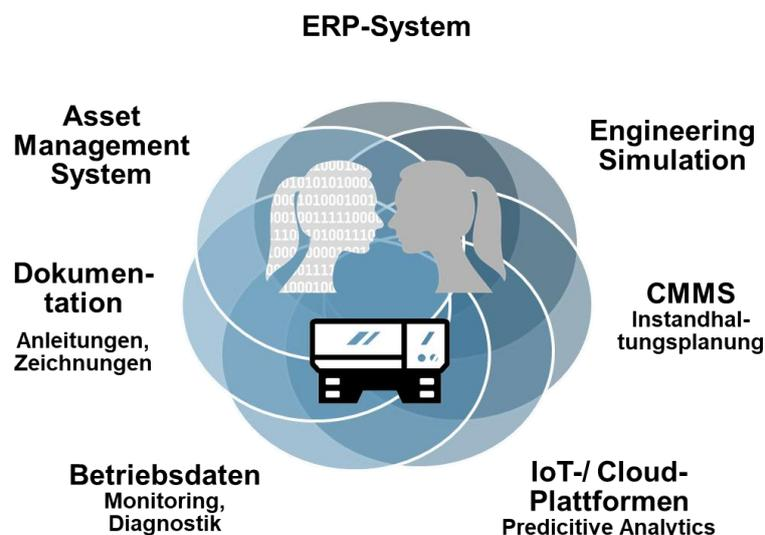
Abbildung 3: Informationsintegration im Digital Twin
