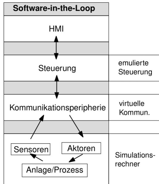
Abbildung 9: Software-in-the-Loop-Simulation
