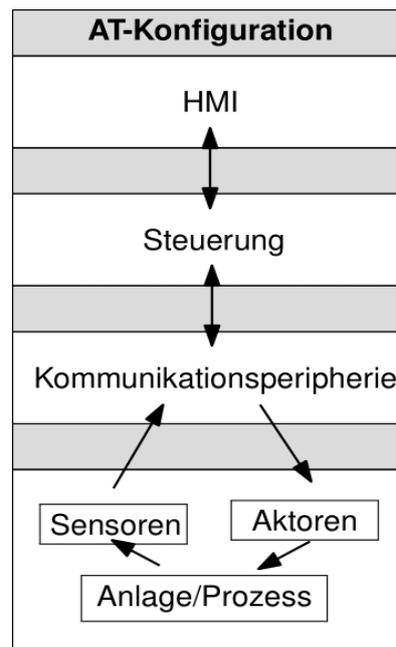
Abbildung 7: Generalisierter Aufbau eines Automatisierungstechnik-Systems (Quelle: [VDI3693])
