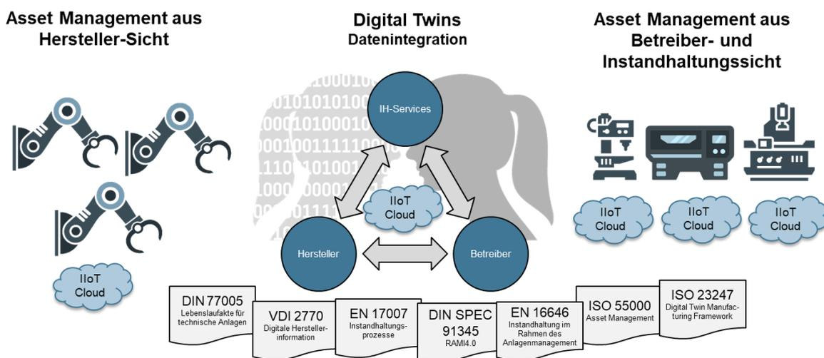
Abbildung 16: Kommunikation zwischen Hersteller, Betreiber und Instandhaltungsservices mit Digital Twins
