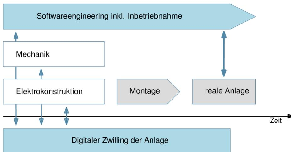
Abbildung 5: Engineering Prozess einer Industrieanlage
