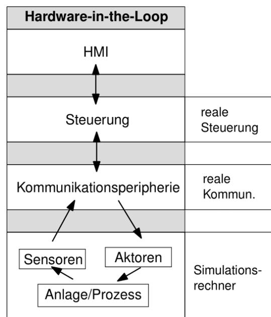
Abbildung 10: Hardware-in-the-Loop-Simulation
